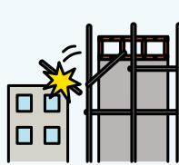
ビル建設工事中に足場が外れて落下し、隣接する建物を損壊した。
